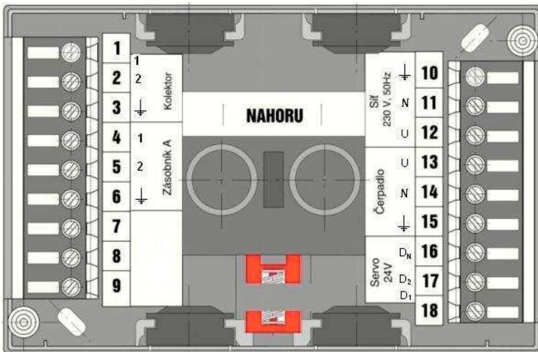
Obr.č. 7 – Schema zapojení svorek – zadní část skříňky sokl
